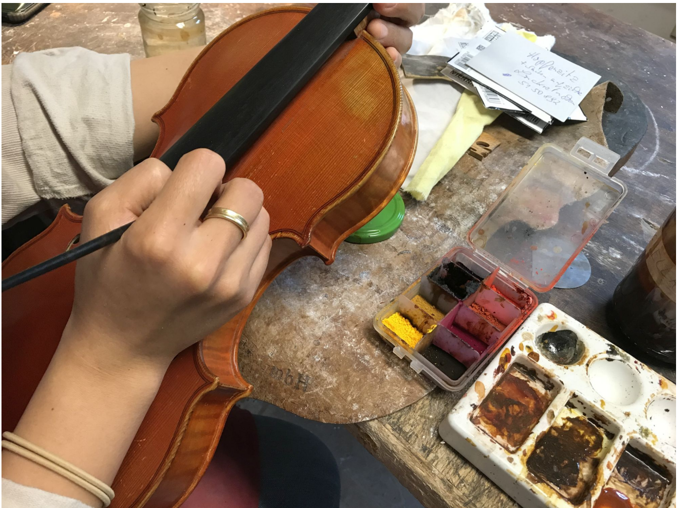
Ausbessern des Lacks auf der Geigendecke (Foto: Konrad Buck für TD)
