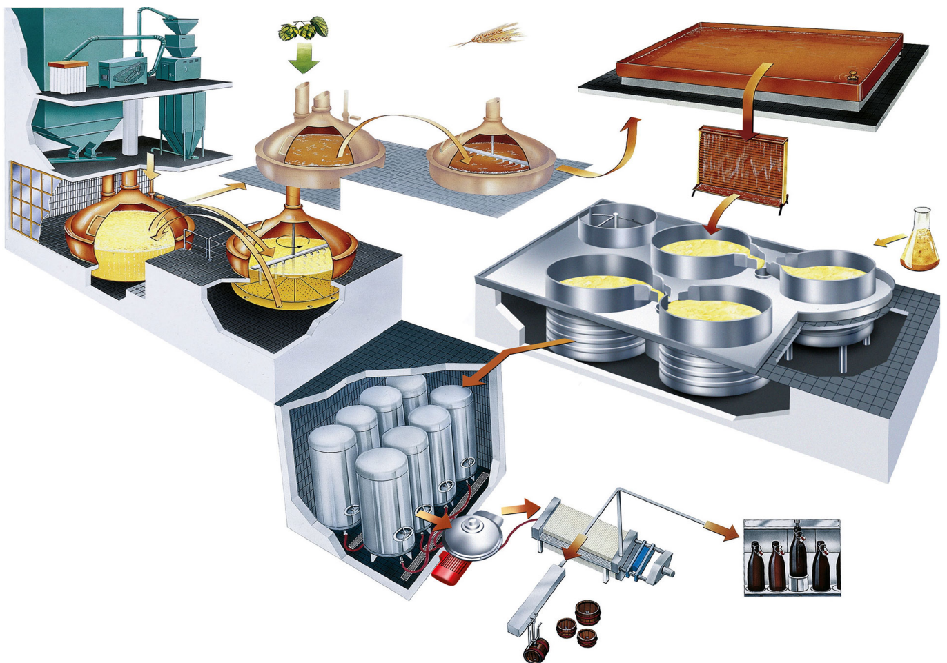
Schematische Darstellung des Brauprozesses (Abb.: Uerige.de)
